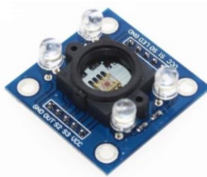
Gambar 2. Sensor Warna GY-31 TCS3200 (Sumber: Kuongshun Elektronik)
