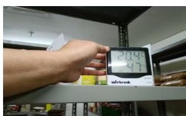
Gambar 1. Alat ukur suhu dan kelembaban di area penyimpanan produk kering ( dry store )
