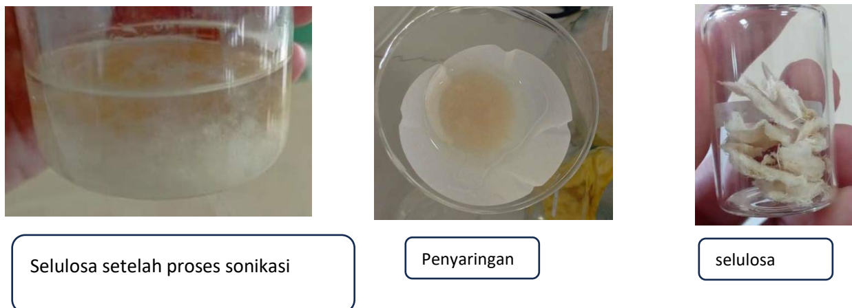
Gambar 2. Selulosa dengan hidrolisis H_2SO_4 10%.
